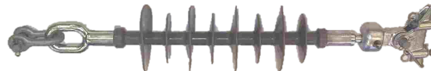
FOTO : EJEMPLO CADENA SUSPENSION 36 KV 70 KN - PESO : 3,07 Kg
